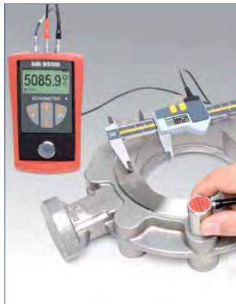
Mesure de la vitesse par ultrasons avec un pied à coulisse connecté pour la transmission automatique des données sur l'épaisseur de la paroi
